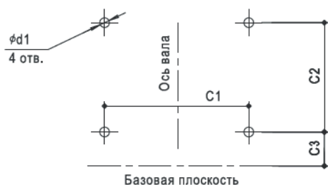
Схема расположения отверстий под фундаментные болты
