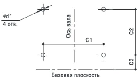
Схема расположения отверстий под фундаментные болты
